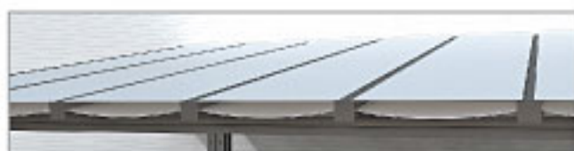
Upper cover tensioned and lower cover wavy Telo superiore teso e telo inferiore ondulato
